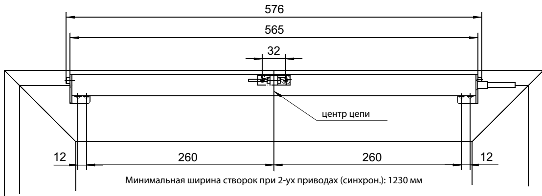
Стандартный монтаж привода Пример: крепление к створке нижнеподвесного окна, открываемого вовнутрь
