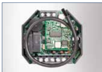
Радиоприемный модуль WRM
